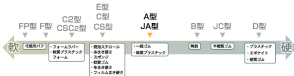
図2 試験材料とデュロメータの型式の簡易的な関係
